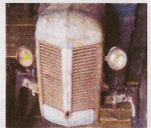
En 1957, c'est l'arrivée du FF30 dont la partie mécanique peinte en rouge sur les modèles français lui vaudra l'appellation de « petit gris au ventre rouge » ! Doté d'un moteur de 30 chevaux (FF30 signifiant Ferguson France de 30 CV), il reste quasiment identique au TE 20.
